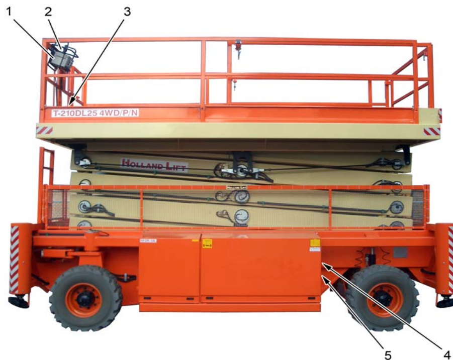
Vue d'ensemble des organes de commande
